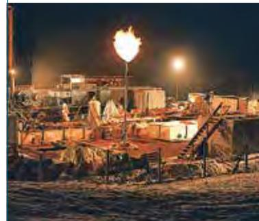
Auch in einer Bohrung der Nagra am Wellenberg (NW) wurde Gas angetroffen. Dieses kleine Vorkommen musste aus Sicherheitsgründen abgefackelt werden.
